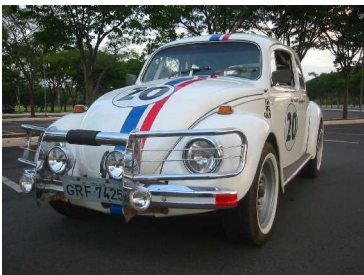
Grade dianteira e para-choques reforçados
